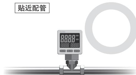
当产品远离原始配管时，延长配管部分的温度变化等外部干扰会导致无法进行精确测量。此外，产品距离原始配管越远，温度传导越慢，响应也越慢。
